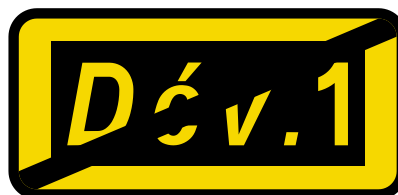
Exemple de panneau de fin de déviation avec le symbole "Dév."
