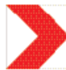
E6 Signal de position d'une déviation ou d'un rétrécissement temporaire de chaussée
