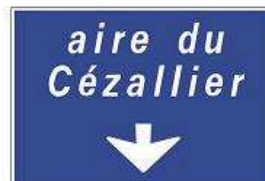
Da32b - exemple Aire annexe autoroutière (sortie par affectation)
